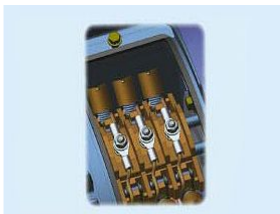
Рисунок 2. Конструкция блока щеткодержателей обеспечивает удобство замены щеток
